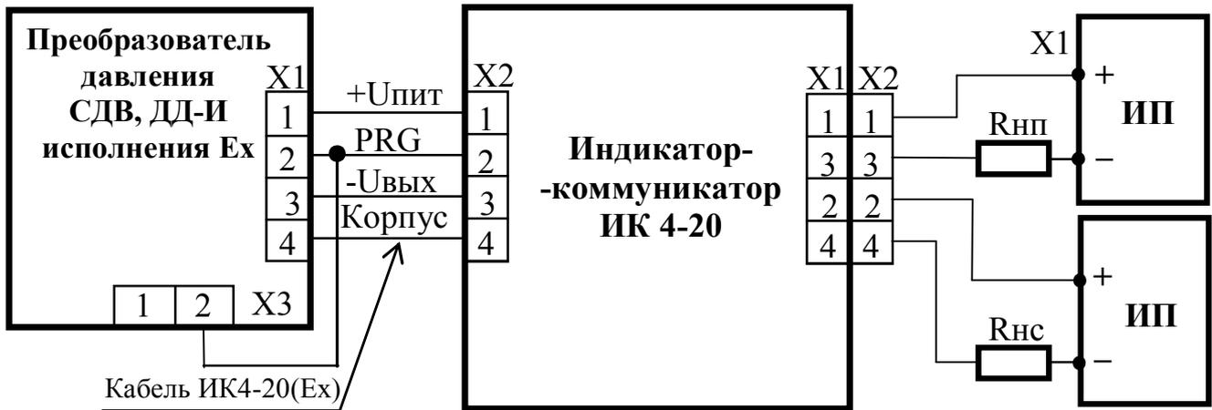
Рисунок А.3 Схема подключения ИК 4-20 к преобразователю с выходным разъемом 2РМД (разъем X3 кабеля не подключать) и преобразователя исполнения Ex (разъем X3 подключить, отвернув крышку) с выходным сигналом 4 – 20 мА
