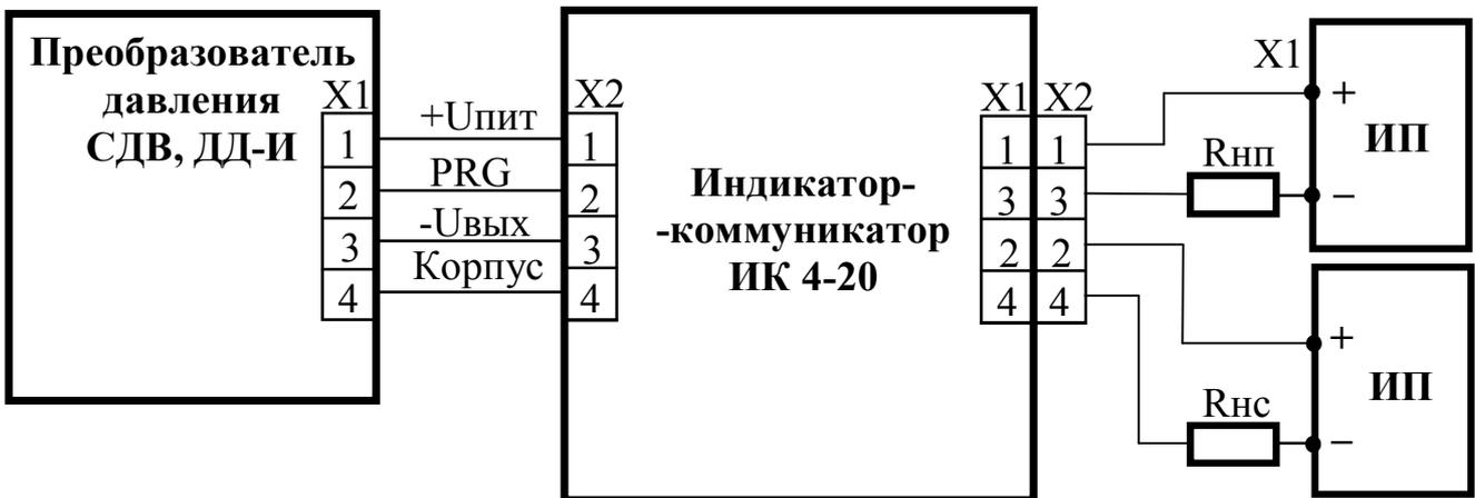
Рисунок А.1 Схема подключения ИК 4-20 к преобразователю давления СДВ или ДД-И общепромышленного исполнения.
