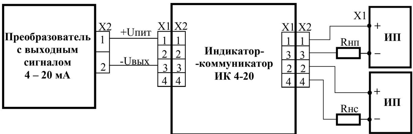
Рисунок А.2 Схема подключения ИК 4-20 к преобразователю с выходным сигналом 4 – 20 мА.
