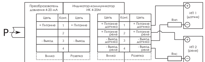
Схема подключения ИК 4-20М к преобразователю с выходным сигналом 4-20 мА («ИП 2» необходим только для работы функции сигнализатора в исполнениях «01» и «02»).
