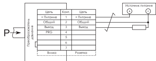
Схема подключения преобразователей с разъемом 2РМДТ 1857Ш1В1В, контакты 6 и 7 вилки соединены перемычкой
