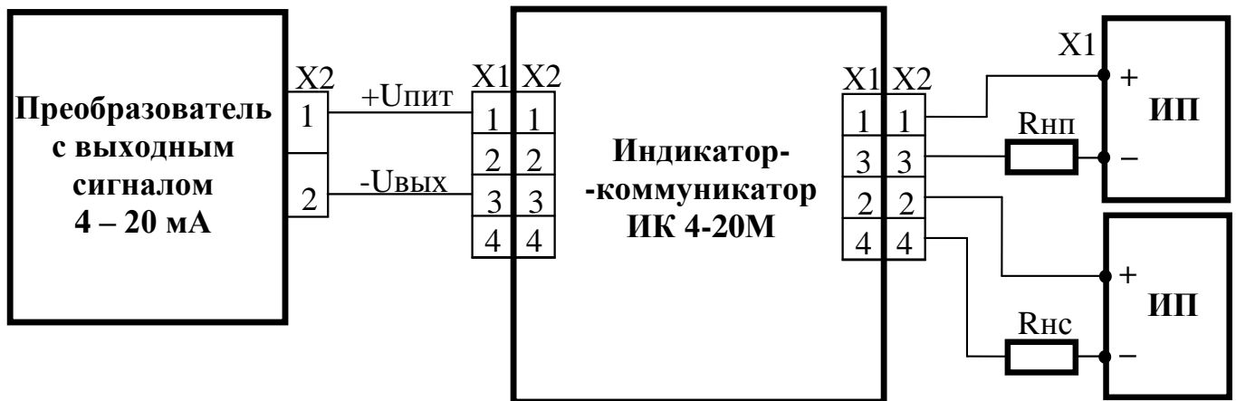
Рисунок А.2 Схема подключения ИК 4-20М к преобразователю с выходным сигналом 4 – 20 мА.
